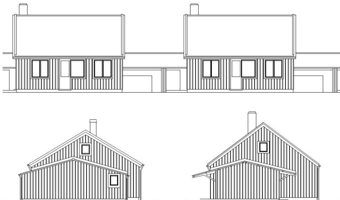
Figur 7 Den övre fasadritningen visar gatufasader från kv. Lidret. Den undre fasadritningen visar gavelfasad med 30 graders taklutning på högdelen, från kv. Skrindan och en fasad där högdelens taklutning är 37 grader, från kv. Lidret.
